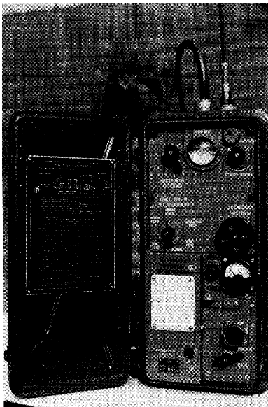
Fig. 11. Frontpaneel van de Russische transceiver. Bovenaan links twee concentrische knoppen voor het aanpassen van de antenne. Daarnaast het vergrootglas waardoor de frequentieschaal afleesbaar is. Rechts daarvan de vergrendeling voor de afstemknop. Links in het midden een schakelaar voor o.a. keuze tussen lokale bediening of bespreken via een telefoonlijn. In het midden rechts de afstemknop. Daaronder een meetinstrument met links daarvan een schakelaar voor keuze tussen meten van batterijspanning of uitgangsspanning. Onderaan links de knop voor het calibratiesignaal (zie tekst). Rechtsonder de aansluiting voor de handmicrofoon en de aan-uitschakelaar. Boven het witte plaatje staat in rode letters: „Pas op! Vijand luistert mee”. (Foto: PAoSE).
